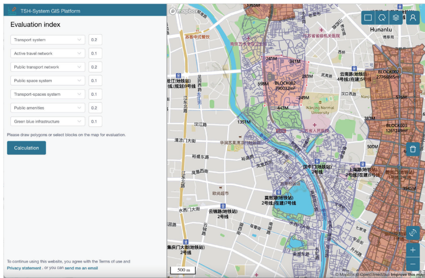
图7 交通与空间系统静态评估模型: 基于GIS网页端的城市交通设施及周边空间的整合度评价工具 Fig.7 A static model for evaluating the complex transport and space systems
